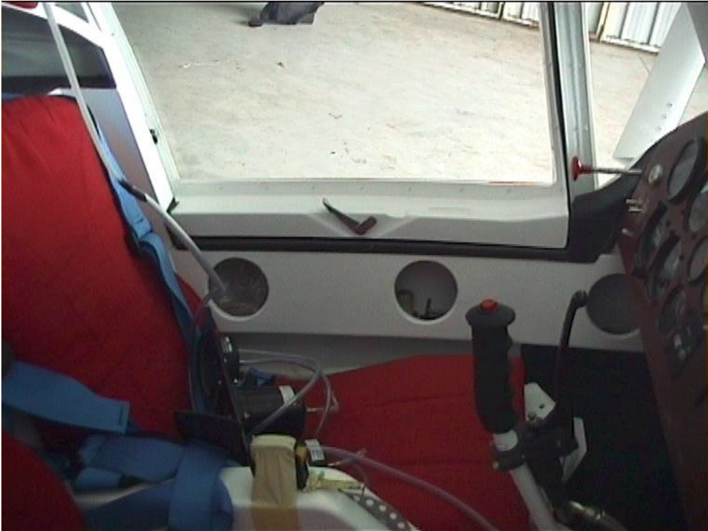
Poignée de porte en position ouverte (correction apportée à cette version afin d'éviter une mauvaise fermeture de la porte, patte vers le bas en position fermée)
