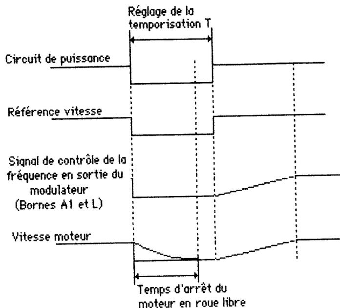
Temporisation sur le circuit de télécommande du contacteur KM
