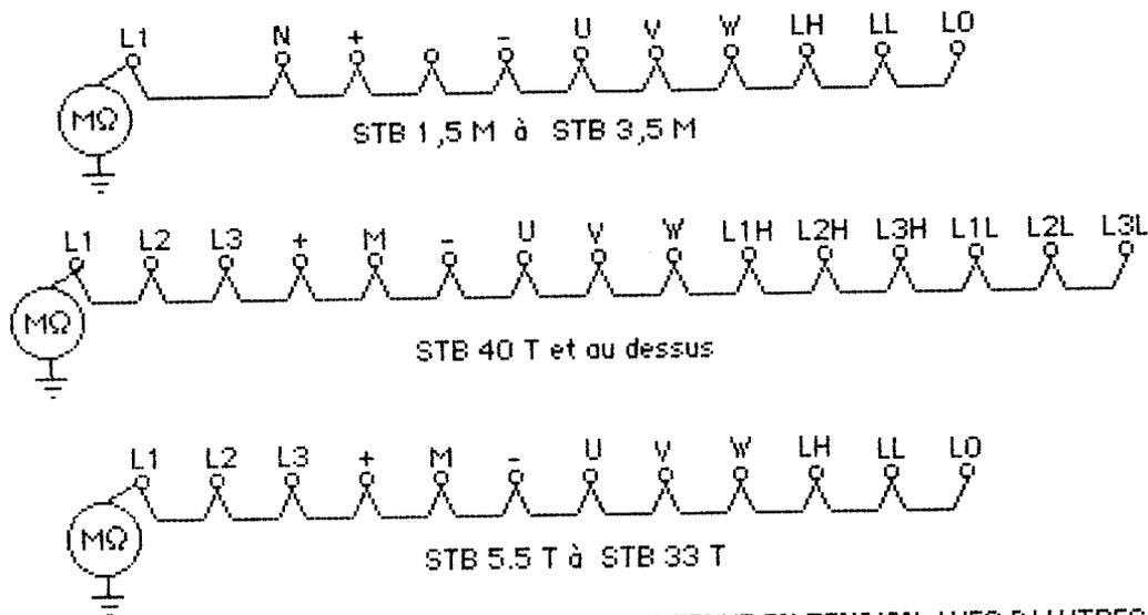
NE PAS FAIRE DE TEST D'ISOLEMENT OU DE TENUE EN TENSION AVEC D'AUTRES BORNES QUE CELLES QUI SONT INDIQUEES CI DESSUS
