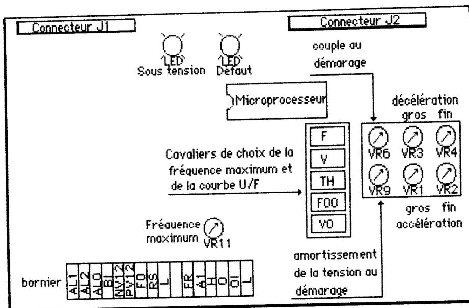
Position des éléments principaux sur le circuit imprimé de contrôle
