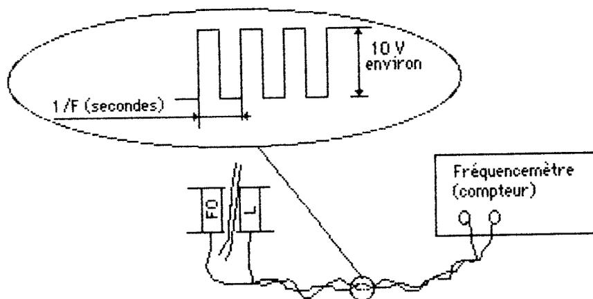
Raccordement d'un fréquencemètre (Compteur)
