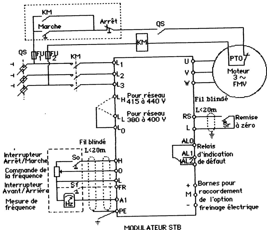
QS: Sectionneur à fusibles (fusibles type AM)      PTO: Protection thermique à ouverture (incluses dans les bobinages des moteurs FMV)
