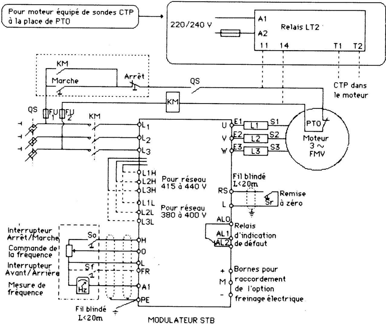
QS: Sectionneur à fusibles (fusibles type AM)      PTO: Protection thermique à ouverture (incluses dans les bobinages des moteurs FMV)
