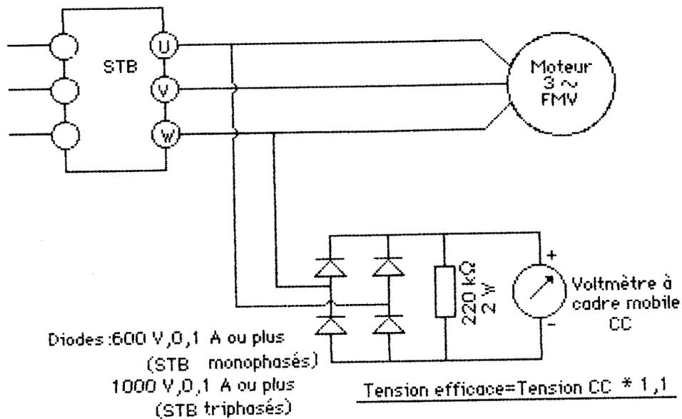
Mesure de la tension de sortie du modulateur en charge
