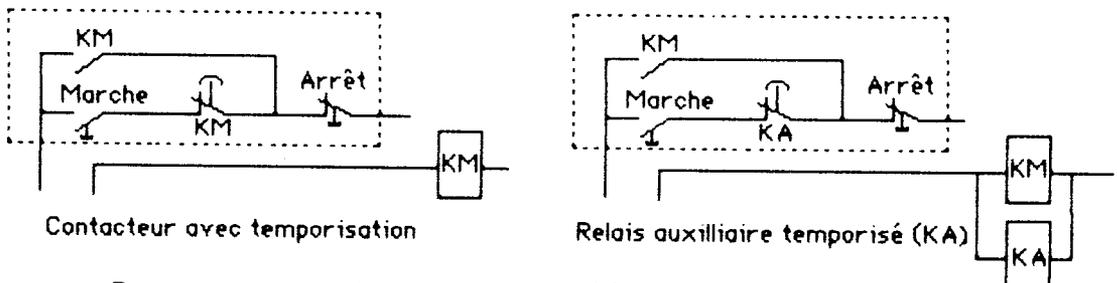
Raccordement avec temporisation sur télécommande
