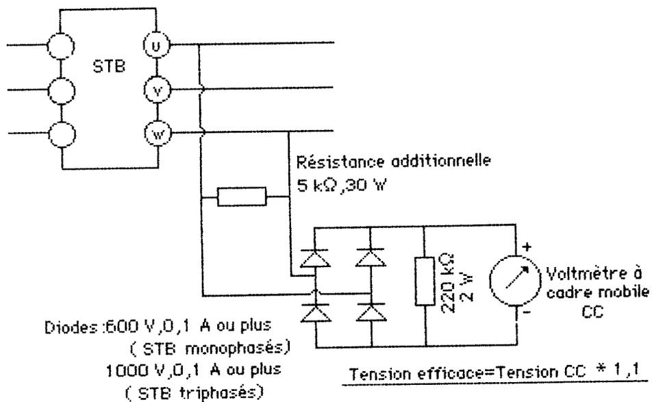
Mesure de la tension de sortie du modulateur à vide
