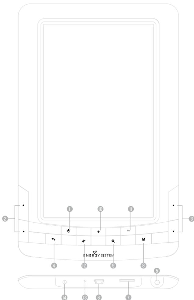
1. **Interrupteur Allumer/Eteindre:** Allume ou éteint le dispositif. Il peut aussi être utilisé pour «pause» ou «reproduire» en mode Multimédia.
