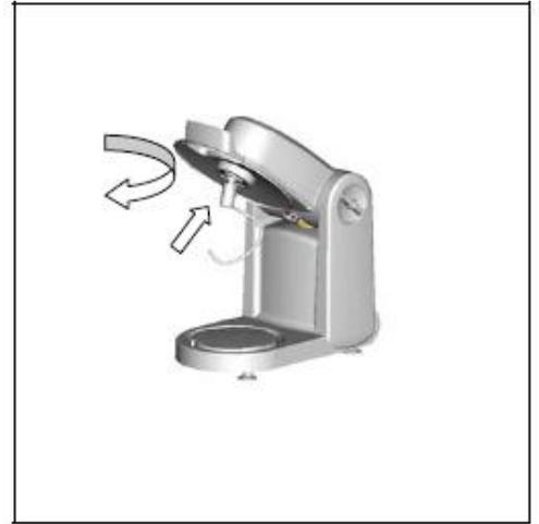
S'assurer que l'axe du moteur à la position montrée Par l'image ci-contre, lors de la fixation de l'accessoire, sinon il risque de rayer la cuve. Si l'axe du moteur n'a pas cette position, abaisser le bras pivotant jusqu'à le fixer.
