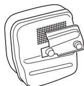
Sur les silencieux sans pot catalytique, la grille doit être nettoyée et si nécessaire remplacée une fois par semaine. Sur les machines dont le silencieux est muni d'un pot catalytique, la grille devra être inspectée et si nécessaire nettoyée une fois par mois. **Si la grille est abîmée, elle devra être remplacée.**
