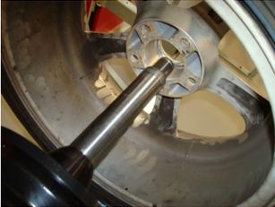
Amener la roue "sans poids" au-dessus de l'arbre de la machine à équilibrer.
