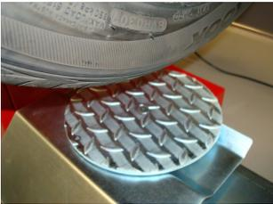
Lorsque la roue est correctement fixée, abaisser la plaque rotative en appuyant sur la pédale de manière à ce que la roue puisse tourner librement.
