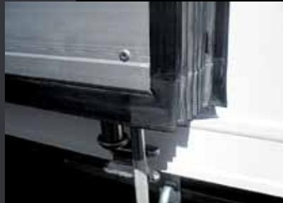
**Joint monobloc haute performance :** Joint cadre monobloc sur profil de porte en composite pultrudé (résine et fibre de verre), insensible aux variations de température. Ses 8 lèvres sont dotées de micro stries améliorant l'étanchéité.
