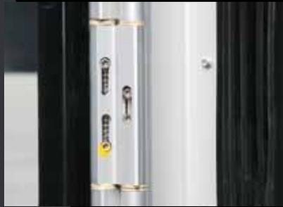
**Cadre arrière nouvelle génération Indéformable** avec équerres acier THLE d'épaisseur 12 mm. Renforcé avec montants verticaux à forte inertie et charnières massives, équipées de bagues anti friction de forte épaisseur. Boulonné pour une maintenance rapide et économique.
