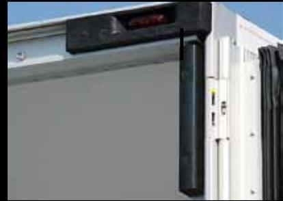
**Butoirs de protection haute du cadre :** Les butoirs de coin protègent les angles et les feux supérieurs à LED.
