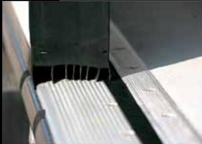
**Portes arrière anti-déperdition :** Les portes constituent une barrière isolante et étanche, avec 90 mm d'épaisseur, des joints 8 lèvres et un seuil intégrant un joint anti-pont thermique.
