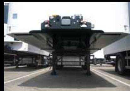
**Module avant avec platelage intégral** sans encastrement, assurant la robustesse de la liaison caisse-châssis au niveau de l'attelage et optimisant la hauteur utile disponible : 2,70 m avec pneumatiques R65, tout en restant dans les 4 m hors tout.
