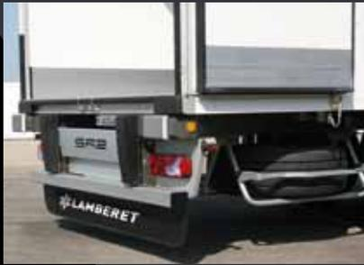
**Système de protection arrière renforcé :** Grands butoirs verticaux en bout de longeron et butoirs amortisseurs élastomère – inox sur le châssis. Cadre équipé de butoirs sur toute la largeur du seuil et sur les montants verticaux (hauteur 600 mm).
