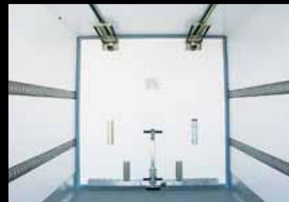
**Cloison transversale mobile :** Ergonomique, dotée d'un joint synthétique réduisant les frottements et ne durcissant pas au froid. Profils protégeant des chocs et optimisant les flux d'air de chaque compartiment.
