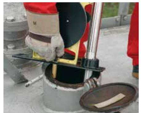
Trou de jaugeage jusqu'à 6 pouces de diamètre
