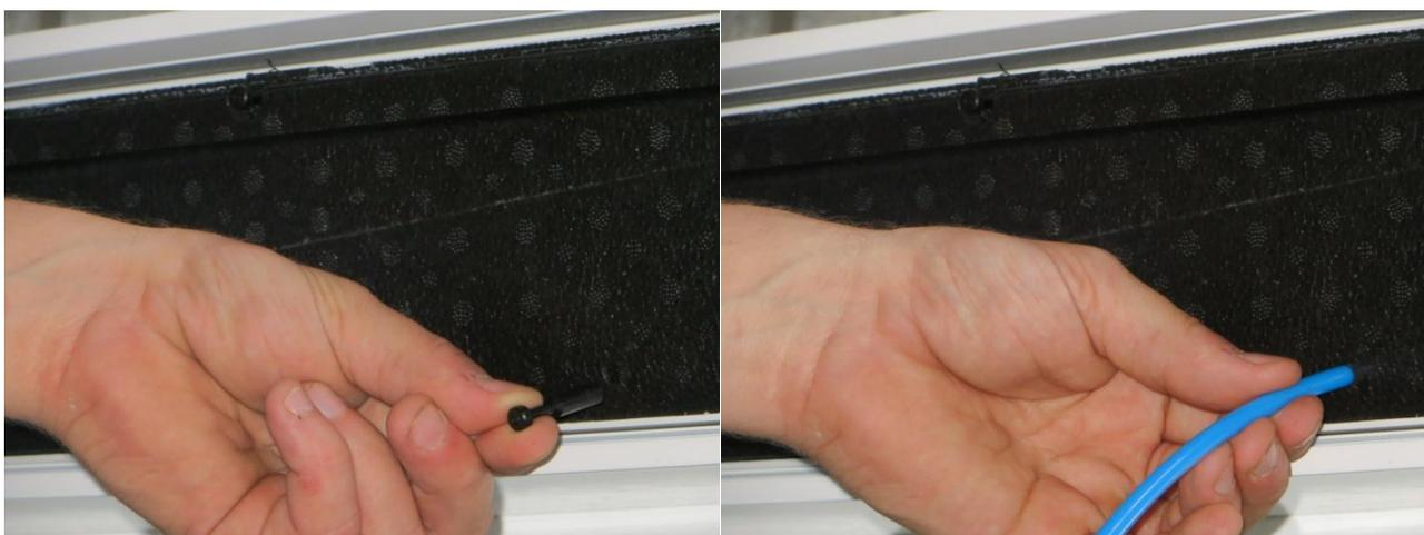
*Figure 18: Prise de pression entre le trou inférieur et l'extérieur.*
