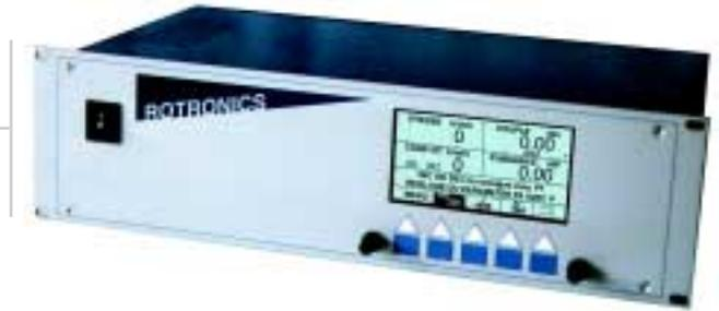
Le **Rack RRN104** est un système de gestion intégrale d'un frein pour banc d'essai. Sa technologie numérique à deux processeurs lui permet de gérer en même temps une régulation rapide et précise du frein, et l'affichage en temps réel des données traitées : vitesse, couple, puissance, charge, consigne en cours et états d'alarmes.
