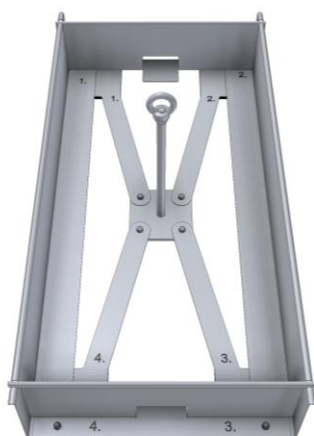
Abb. 7: Fertig montierte Randeinfassung
