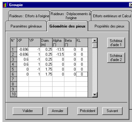
Figure H.3 : Module GROUPIE – Géométrie des pieux.
