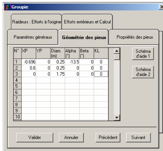
Figure H.66 : Module GROUPIE – Géométrie des pieux
