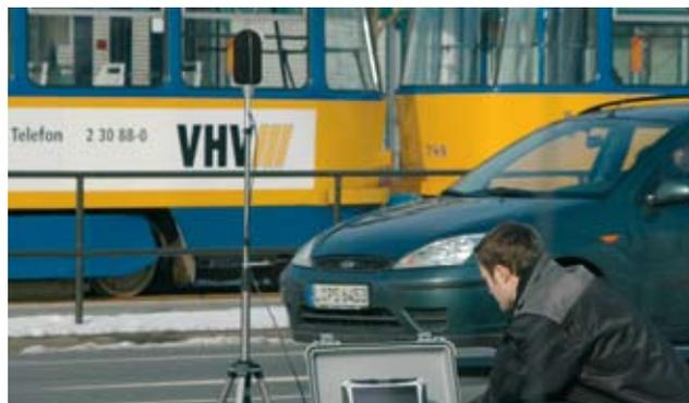
Outres les sonomètres portatifs classiques, idéals pour les mesures de courtes durées sur site, nous proposons également des solutions PC. Le système multi-canal Soundbook s'adapte remarquablement à ce type de mesurages. Il fournit de nombreuses analyses pour chaque canal (niveau de pression acoustique, enregistrement des signaux, analyse temporelle), toutes disponibles simultanément.
