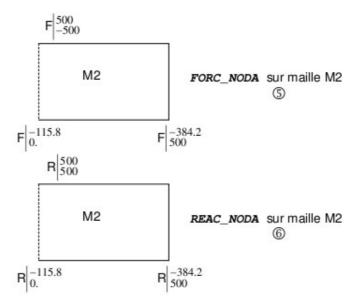
Sur cet exemple, les réactions aux nœuds (2) sont bien égales aux forces nodales (1) moins le chargement. Elles représentent les réactions aux appuis de la structure.
