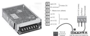
Figure 2. Raccordement du bloc d'alimentation (SMPS)
