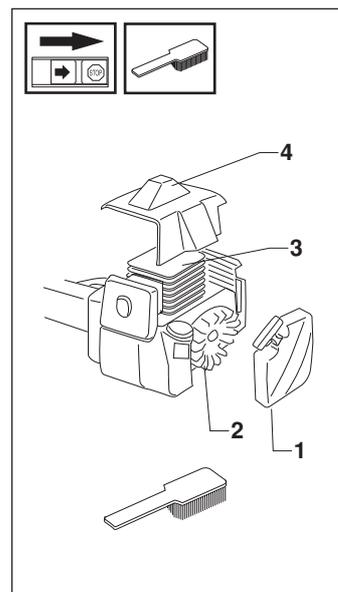
A l'aide d'une brosse, nettoyer le circuit de refroidissement une fois par semaine, en cas de conditions de service difficiles, plus souvent. **Un circuit de refroidissement encrassé ou obstrué entraîne une surchauffe du moteur pouvant résulter en des dommages au cylindre et au piston.**
