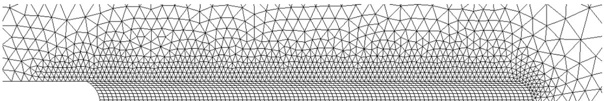
Figure 3-2 - Maillage classique avec définition des copeaux.
