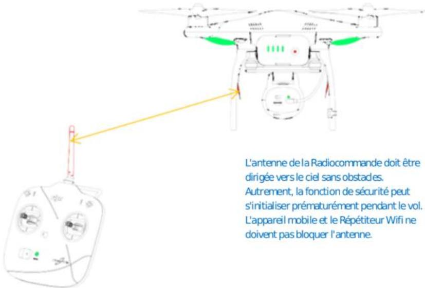
L'antenne de la Radiocommande doit être dirigée vers le ciel sans obstacles. Autrement, la fonction de sécurité peut s'initialiser prématurément pendant le vol. L'appareil mobile et le Répétiteur Wifi ne doivent pas bloquer l'antenne.
