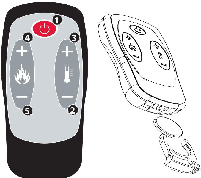
**!** Si la télécommande est éteinte à cause de l'absence de la pile, il est possible de commander le poêle depuis le panneau de commandes placé dans la partie supérieure du poêle.
