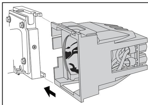
11. Alignez les encoches et les languettes sur le côté droit de la façade et du bras de projection comme sur l'illustration, puis encliquez-les.
