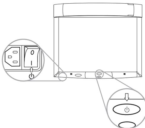
3. Appuyez sur le **bouton Marche/Arrêt** au centre de la façade inférieure. Le bras de projection se dégage de son logement au sommet du 3M Digital Wall Display. Ne bloquez pas son mouvement.
