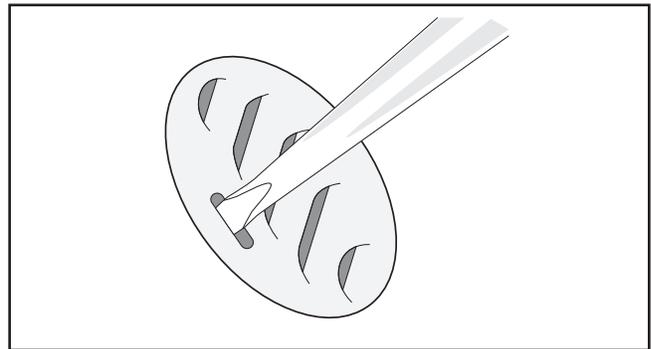
3. Localisez la vis de réglage pour l'ajustement d'un côté à l'autre de l'écran. Localisez la vis de blocage pour l'ajustement d'un côté à l'autre de l'écran.
