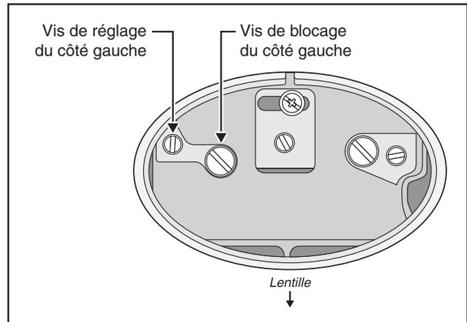
8. Désérrez la vis de blocage. Utilisez alors une lame de tournevis sur la vis de réglage pour déplacer l'image de l'écran de haut en bas si nécessaire. Serrez la vis de blocage.
