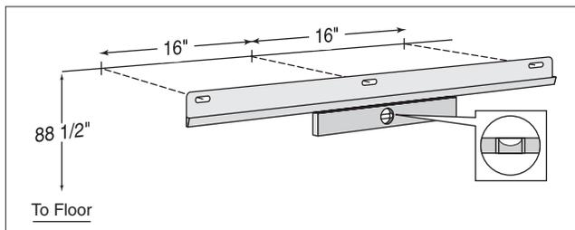
3. A l'aide d'un tournevis Phillips, vissez les fixations fournies, dans le mur, jusqu'à ce qu'elles se confondent avec la surface du mur.
