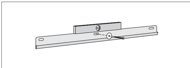
**Note:** Pour d'autres types de matériaux de mur (bois, ciment, bloc de béton), utilisez des fournitures correctement calibrées pour le poids de l'unité et pour un matériau de mur déterminé.
