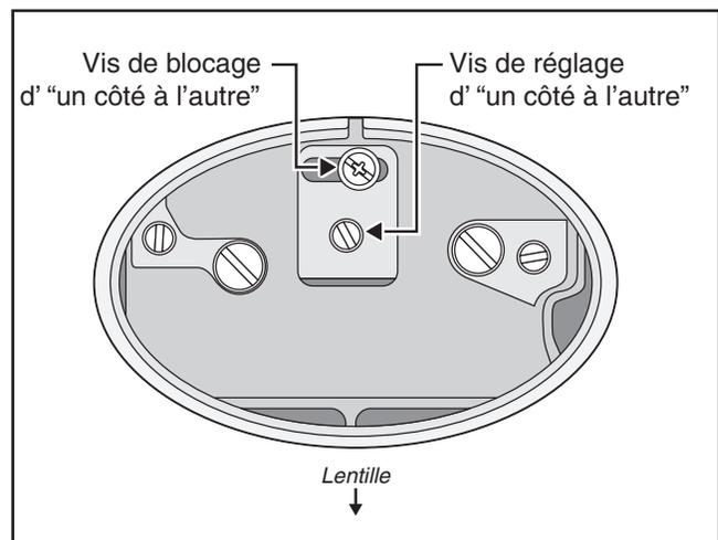
4. Désérrez la vis de blocage. Utilisez alors une lame de tournevis sur la vis de réglage pour déplacer l'image de l'écran d'un côté à l'autre si nécessaire. Serrez la vis de blocage.
