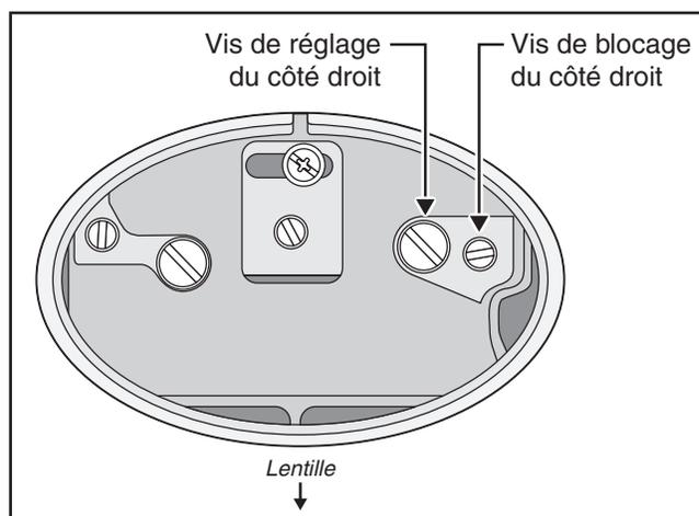
6. Désérrez la vis de blocage. Utilisez alors une lame de tournevis sur la vis de réglage pour déplacer l'image de l'écran de haut en bas si nécessaire. Serrez la vis de blocage.
