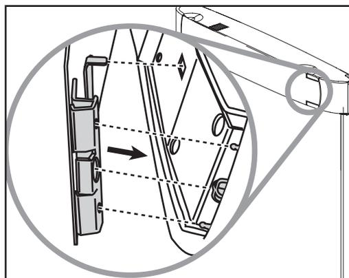
12. Alignez les encoches et les languettes sur le côté gauche de la façade et de la tête de projection comme sur l'illustration, puis encliquez-les.
