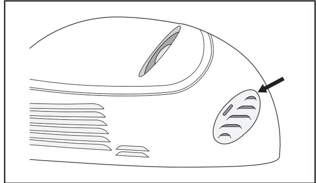
2. Avec la lame d'un petit tournevis poussez la languette de fermeture de la porte en position d'ouverture. Précautionneusement, soulevez vers l'extérieur pour enlever la porte du moteur optique.
