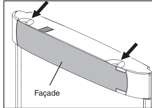
4. Desserrez la vis incorporée située dans le coin supérieur droit du couvercle de logement de la lampe à l'aide d'un tournevis standard.
