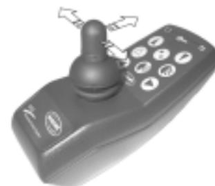
Avec la commande 3 directions sont sélectionnés et commandés, outre les ordres de déplacement, tous les éléments de réglage du fauteuil roulant au moyen des **3 directions de mouvement** du joystick.
