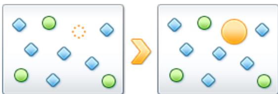
Juste après le démarrage d'un programme (en orange), la puissance de calcul de l'ordinateur est brièvement redistribuée, ce qui permet au programme en cours de démarrage d'être spécifiquement accéléré. Ce programme passe momentanément à un niveau de priorité supérieur. Cette mesure n'affecte nullement tous les autres programmes (en vert et en bleu).
