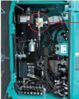
Vanne de sélection simple ou double effets du circuit hydraulique auxiliaire
