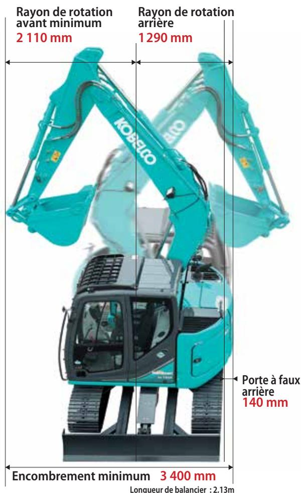
L'encombrement minimum est la somme du rayon de rotation avant minimum et du rayon de rotation arrière.
