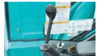
Commutateur additionnel de sélection de la vitesse de translation sur le levier de commande de la lame
