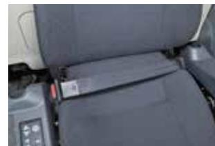
La ceinture de sécurité à enrouleur ne nécessite aucun réglage manuel
