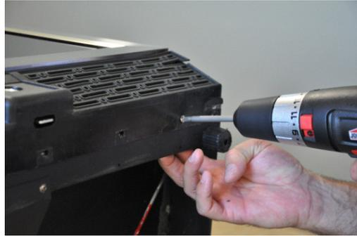
**Réinstaller la grille de ventilation à l'aide des 10 vis**
