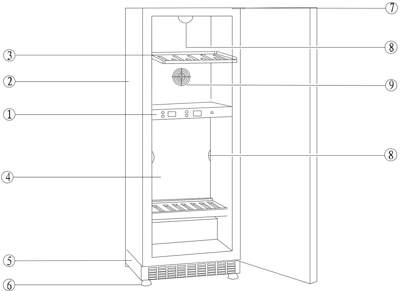
1. PANNEAU DE CONTRÔLE & REGLAGE DE TEMPERATURE
