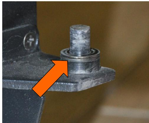
Conservez les bagues de nivellement et les remettre en position sur le nouveau pivot qui sera installé à l'étape 10
