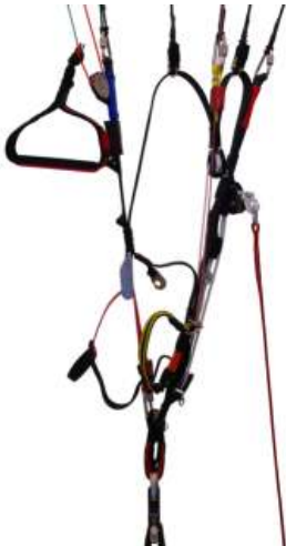
Poulie en seconde position (haute) ; aimant EK placé au dessus de la position médiane de la poulie.
