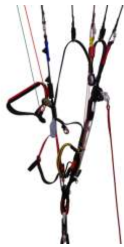
Poulie en première position (basse) : aimant EK placé au dessus de la boucle de trims
