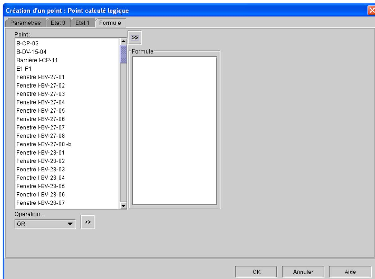
Ce panneau permet de définir une formule pour un point calculé. Pour remplir une formule, il faut sélectionner un point, une opération. Suivant le type du point les opérations possibles sont différentes.
