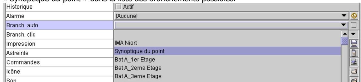
Lors du fonctionnement du point au sein de CASTELSuperviseur, le branchement automatique se fera sur le synoptique du point
