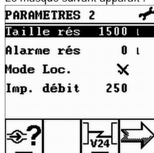
2. Dans la ligne Alarme rés, saisir le volume auquel l'alarme de réservoir doit être activée lorsqu'il tombe en dessous de la limite.
