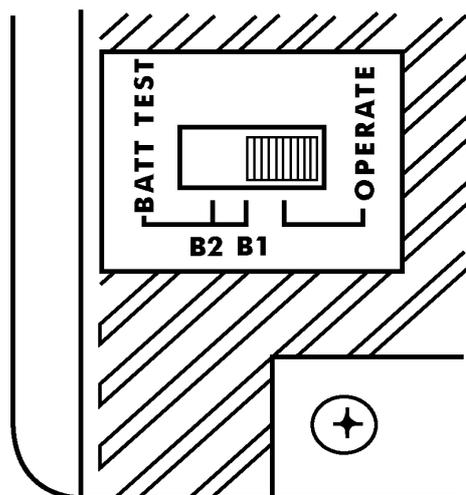
Si le pointeur du vumètre se trouve dans la zone verte de l'échelle **BATT**, les piles sont suffisamment puissantes. Sinon, remplacez les piles.
