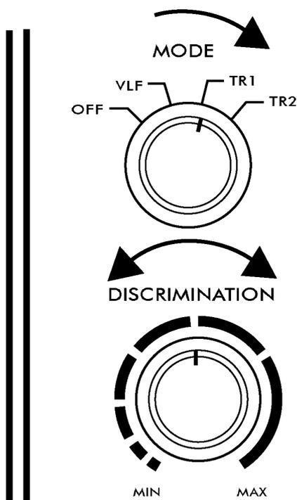
Placez-le sur **VLF** pour tester l'état des piles et réglez **TUNE** et **GROUND**. (Voir "Réglage du détecteur" et "Réglage du TERRAIN").
