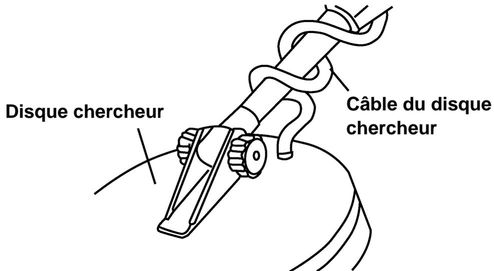
6. Insérez la fiche du disque chercheur dans la prise du disque chercheur sur le boîtier de commande du détecteur. Veillez à ce que les contacts de la fiche correspondent bien aux trous de la prise.
