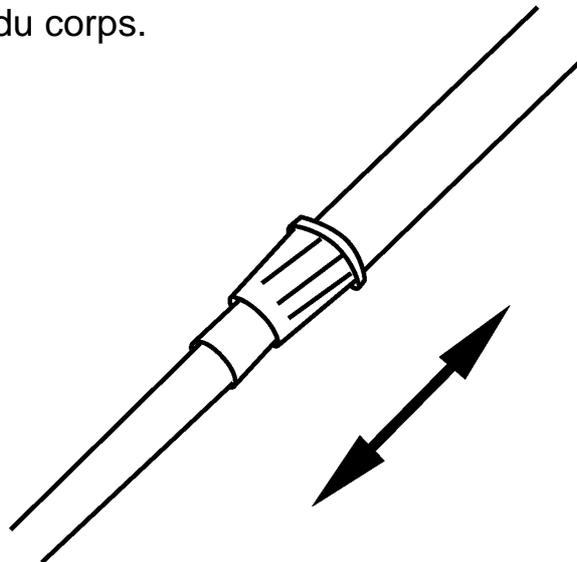
3. Tournez l'écrou de fixation du tube dans le sens inverse à celui des aiguilles d'une montre pour le fixer en place.
