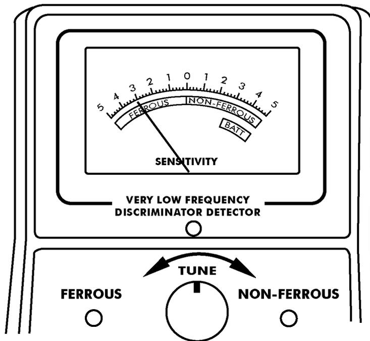
Si le détecteur ne détecte pas l'objet, vérifiez l'état des piles et la connexion du disque chercheur. Il se peut que vous deviez également affiner le réglage du détecteur (voir "Affinage du réglage du détecteur").
