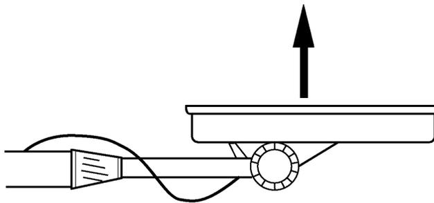
**NOTE :** Ne testez jamais le détecteur sur un plancher à l'intérieur d'un bâtiment à étages multiples. La plupart de ces bâtiments comportent une armature métallique dans le plancher, qui peut interférer avec les objets que vous testez ou masquer complètement le signal.
