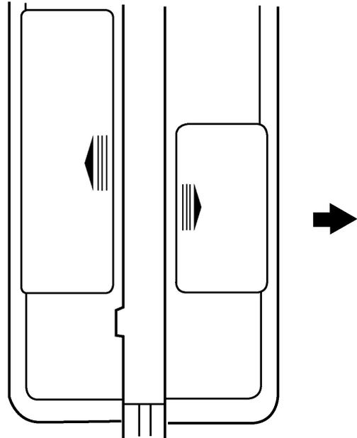
3. Placez une pile 9 volt dans le compartiment des piles au-dessus du ruban, en respectant les symboles de polarité (+ et -) indiqués à l'intérieur.
