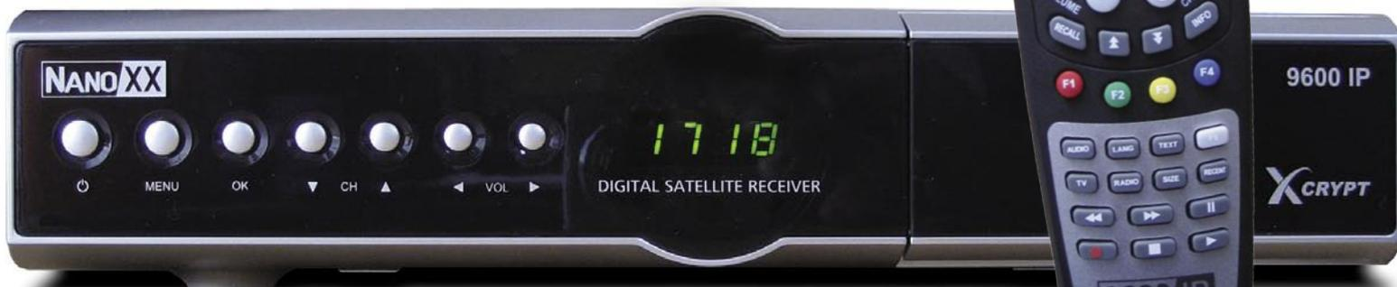
Le boîtier de ce récepteur est d'un aspect argenté très élégant avec un panneau avant noir brillant où un afficheur à segments facile à lire indique le numéro de la station actuellement activée. Vers la gauche, Nanoxx dispose de sept boutons pour pouvoir opérer le récepteur sans avoir recours à sa télécommande et vers la droite un clapet dissimule le lecteur de cartes qui est compatible XCrypt.
