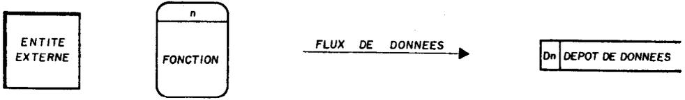
Fig. 2a - Les diagrammes de flux de données sont construits avec seulement quatre types de symboles
