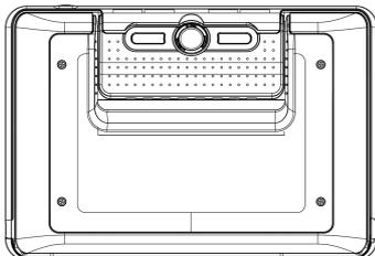
La caméra du Compact 7 HD se trouve à l'arrière de l'appareil. À la gauche et à la droite de la caméra, il y a deux lumières d'objet qui sont employées lorsque l'appareil est utilisé dans la position fermée.
