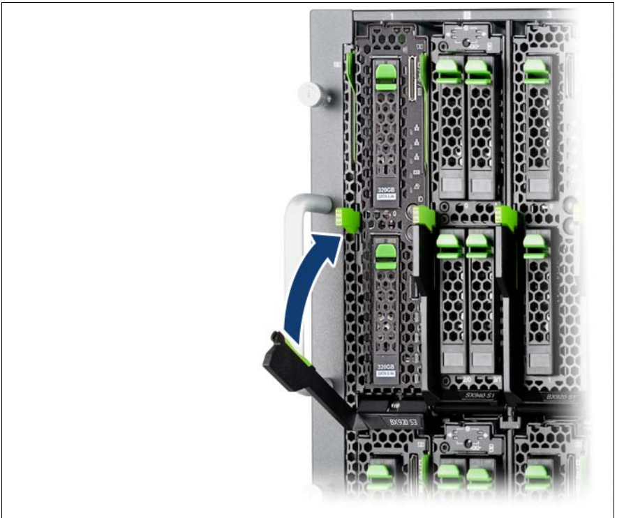
Image n° 4 : Verrouillage du server blade
