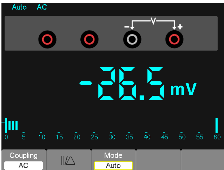
Schéma 7-7 Mesure de la tension AC
