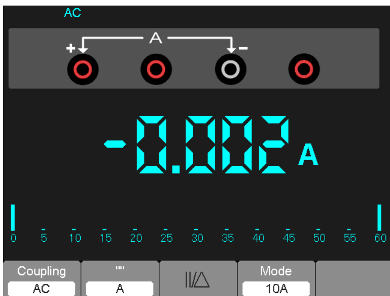
Schéma 7-11 Mesure du courant AC de 10 A
