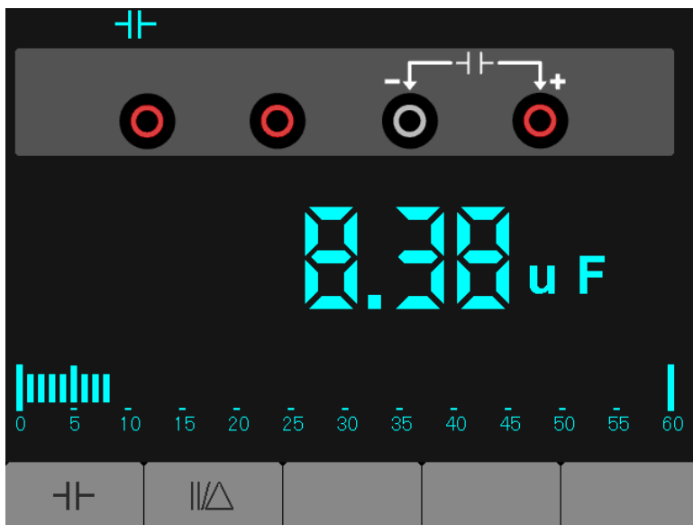
Schéma 7-5 Mesure de la capacité
