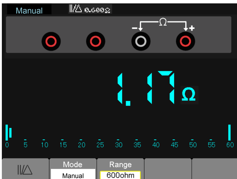
Schéma 7-12 Mesure relative
