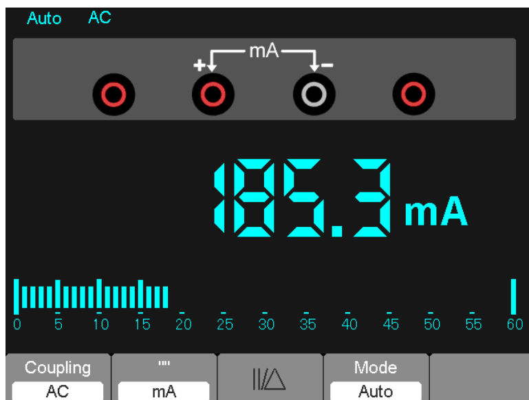
Schéma 7-10 Mesure du courant AC pour 600 mA
