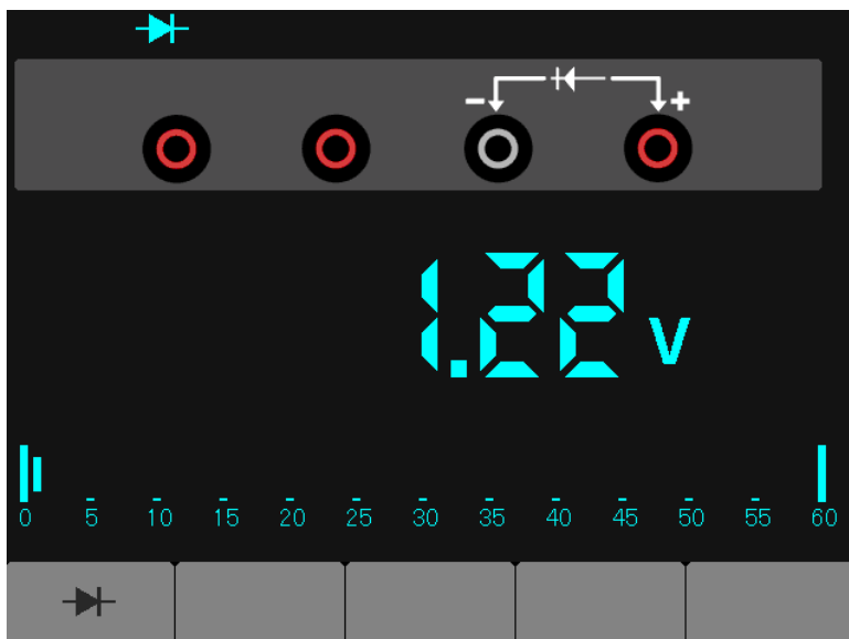
Schéma 7-3 Mesure de diode
