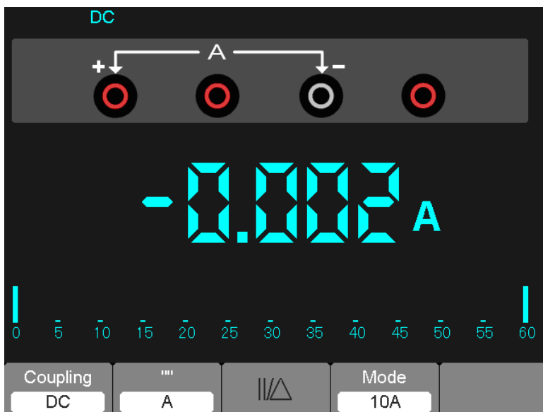
Schéma 7-9 Mesure du courant DC de 10 A
