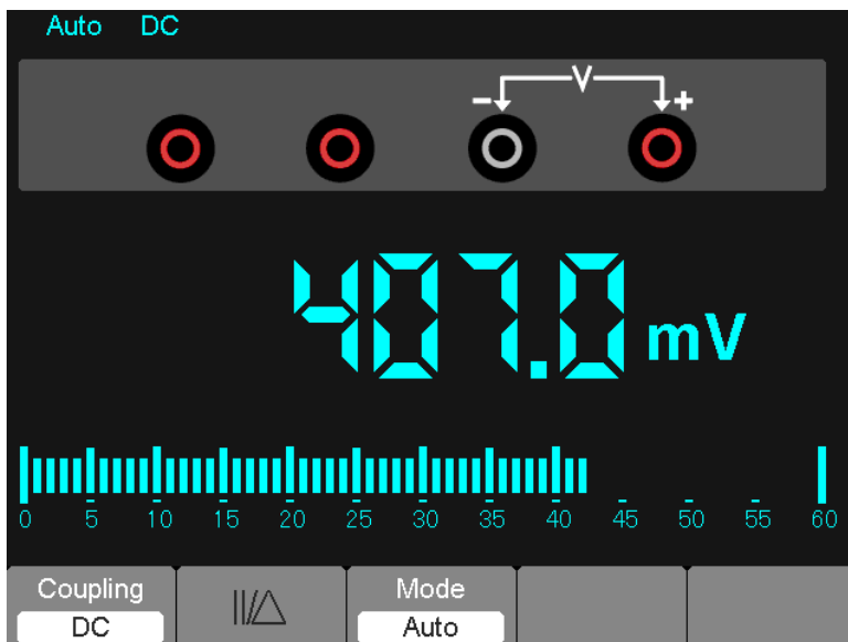
Schéma 7-6 Mesure de la tension DC
