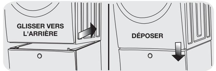
2. Ajustez les côtés de l'électroménager d'un côté à l'autre afin d'aligner ses trous de montage avec les trous des supports du socle.
