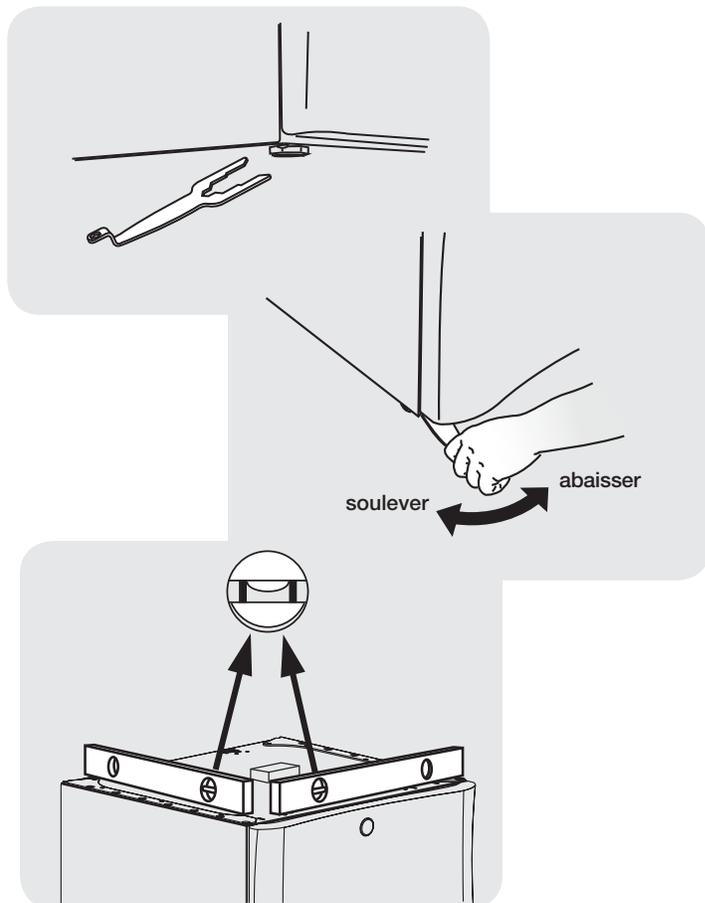
3. Balancez le socle d'un coin à l'autre pour en vérifier la stabilité. Répétez la mise à niveau et le balancement jusqu'à ce que les quatre (4) pieds soient posés solidement sur le plancher et que le socle soit au niveau.
