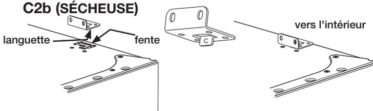
3. Installez 2 vis dans chaque support arrière en alignant les trous du socle.
