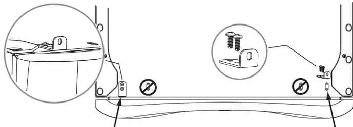
2. Insérez la languette « C » de chaque support arrière dans les fentes les plus larges à l'arrière du socle. Orientez le support vers l'extérieur pour un montage sur une laveuse (image C2a). Orientez le support vers l'intérieur pour un montage sur une sècheuse (image C2b).
