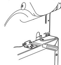
4. Avec le tiroir du socle ouvert pour faciliter l'accès, installez une vis dans chaque support avant et dans la base de la laveuse ou de la sècheuse.
