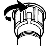
Verrouillez la prise en la tournant dans le sens des aiguilles d'une montre.
