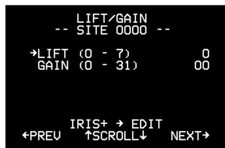
Le gain permet d'optimiser la luminosité de la vidéo lorsque la longueur du câble coaxial est importante (Figure 27). Le gain accroît l'amplitude du signal vidéo afin d'augmenter la luminosité des vidéos assombries et de réduire le bruit des vidéos affaiblies. Utilisez le manche pour régler le gain. Poussez-le vers haut pour augmenter le gain et vers le bas pour le diminuer.
