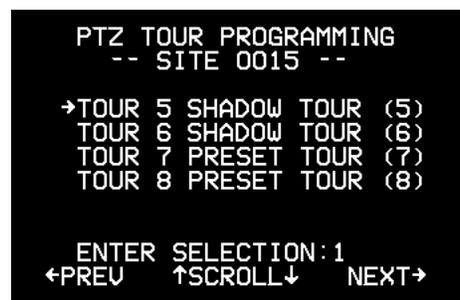
2. Sélectionnez le circuit à modifier. Les menus *Tour programming* (Programmation d'un circuit) s'affichent (Figure 62).
