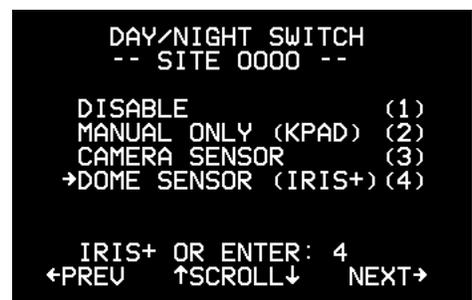
Si vous sélectionnez le capteur du bras articulé de l'unité de réglage PTZ, vous devez indiquer le niveau de commutation (Figure 20). Le point de commutation du niveau de lumière est réglable mais il doit être défini uniquement dans les conditions d'aube/de crépuscule.
