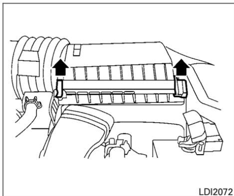
Le filtre à air ne doit pas être nettoyé et réutilisé. Vous devez le remplacer conformément au programme d'entretien du « Guide d'entretien et de réparation NISSAN ». Au moment du remplacement, essuyez l'intérieur du boîtier et le couvercle du filtre à air avec un chiffon humide.
