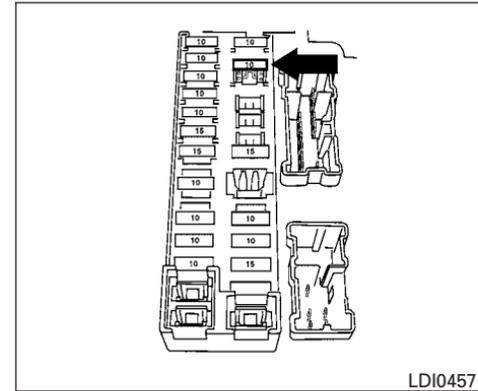
Lorsqu'un fusible de type A est utilisé en remplacement d'un fusible de type B, il ne sera pas logé aussi profondément que ceux de type B (voir l'illustration). Ce fusible assurera la protection du circuit de même manière. Vérifiez que le fusible est bien enfoncé dans la boîte à fusibles.
