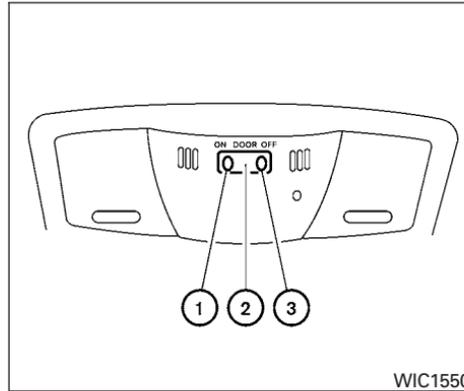
L'éclairage intérieur est commandé par un commutateur à trois positions. L'éclairage fonctionne quelle que soit la position du commutateur d'allumage.
