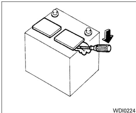
1. Retirez les bouchons d'aération au moyen d'un tournevis, tel qu'illustré. Servez-vous d'un chiffon pour protéger le boîtier de la batterie.
