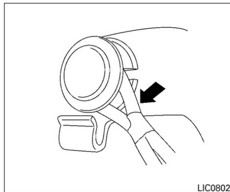
Pour installer un filet d'arrimage, attachez-en les crochets aux dispositifs de retenue.
