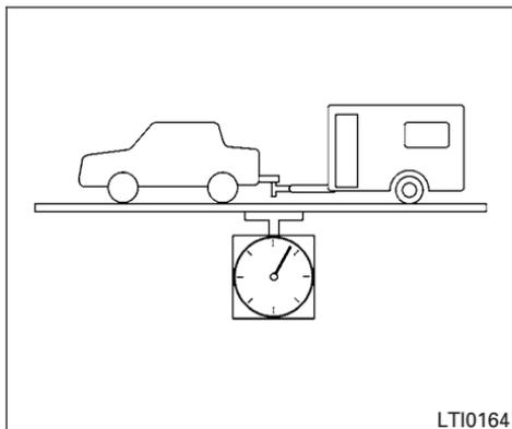
Le poids technique maximal combiné (PTMC) correspond au poids combiné du véhicule tracteur (incluant les passagers et les bagages) et de la charge totale de la remorque. Une charge de remorquage supérieure à la limite spécifiée ou l'utilisation d'un équipement de traction de remorque inadéquat peut compromettre le comportement routier, le freinage et le rendement du véhicule.
