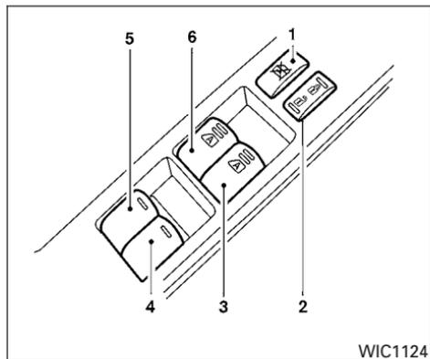
1. Interrupteur de verrouillage des glaces
