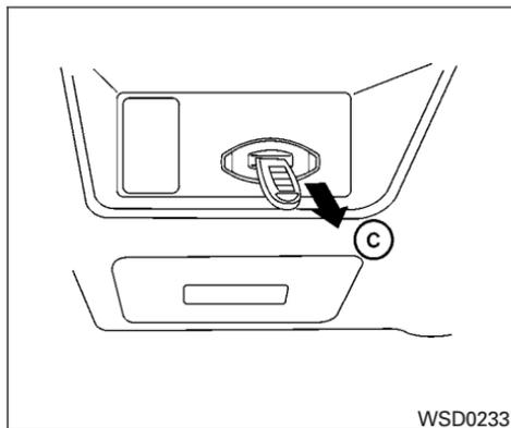
Pour retirer la clé intelligente de son récepteur, enfoncez le commutateur d'allumage à bouton-poussoir à la position LOCK (antivol-verrouillé) et tirez la clé intelligente hors de son récepteur ©.
