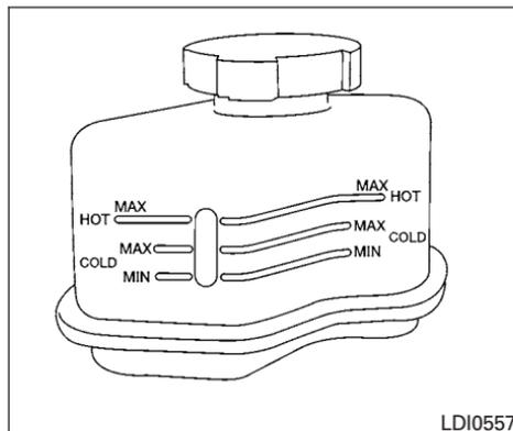
Le niveau de liquide doit être situé entre les repères MIN et MAX HOT (chaud) du réservoir de liquide de direction assistée à des températures de liquide de 50 °C à 80 °C (122 °F à 176 °F), ou entre les repères MIN et MAX COLD (froid), à des températures de liquide de 0 °C à 30 °C (32 °F à 86 °F).
