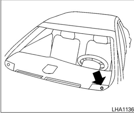
Le capteur d'ensoleillement, situé du côté conducteur sur le dessus du tableau de bord, favorise le maintien d'une température constante. Ne déposez rien sur le capteur ou à proximité de celui-ci.
