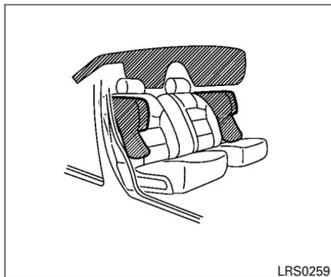
Système de sacs gonflables latéraux montés dans les sièges avant et rideaux gonflables latéraux montés dans le toit
