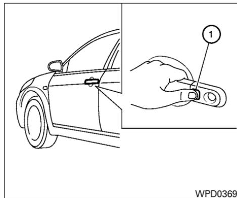
portière à sa position d'origine pour déverrouiller la portière. Si la portière ne se déverrouille pas lorsque la poignée de portière revient à sa position d'origine, enfoncez le commutateur de demande de poignée de portière pour déverrouiller la portière.
