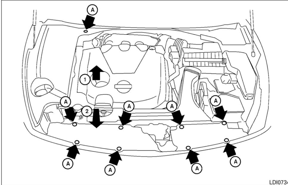
Pour retirer les couvercles du compartiment moteur, dégrafez les attaches **A** qui se trouvent aux emplacements illustrés.
