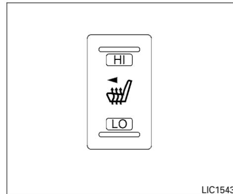
Les sièges avant sont chauffés par des dispositifs de chauffage intégrés. Le commutateur se trouve sur la console centrale.
