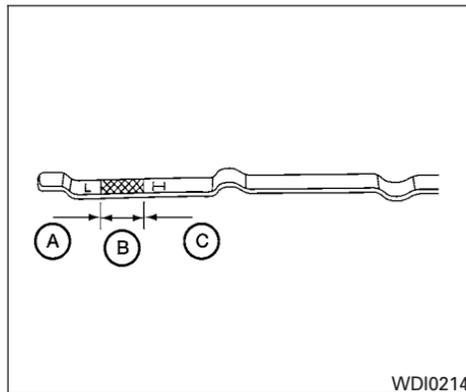
5. Retirez-la de nouveau et vérifiez le niveau d'huile. Celui-ci doit se trouver entre les repères H (élevé) et L (bas) (B). Il s'agit du niveau d'huile normal. Si le niveau d'huile est sous le repère L (bas), retirez le bouchon de remplissage d'huile et versez de l'huile dans l'orifice (A). **Ne remplissez pas le réservoir au-delà de sa capacité (C).**
