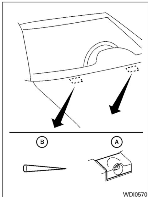
Assurez-vous que rien ne s'infiltré dans le gicleur de lave-glace (A). Un colmatage ou un mauvais fonctionnement du lave-glace pourrait en résulter. Si le gicleur est bouché, dégagez l'orifice au moyen d'une aiguille ou d'une petite épingle (B).
