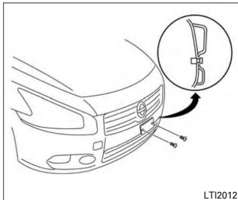
Pour installer la plaque d'immatriculation à l'avant, fixez le support de plaque d'immatriculation sur l'enjoliveur en plastique aux marques d'emplacement (petites cavités) à l'aide des deux vis de 6 mm fournies à cet effet.
