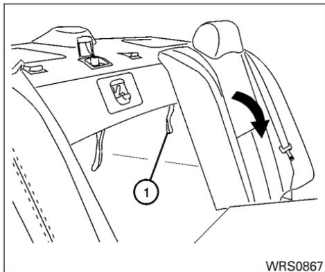
Pour rabattre le dossier du siège arrière du côté du conducteur, passez la main dans l'ouverture et tirez sur la sangle (1) située derrière le siège.
