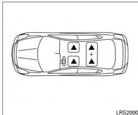
L'illustration montre les places assises dotées d'un appuie-tête. Les appuie-tête des places latérales arrière sont réglables et amovibles. L'appuie-tête de la place centrale arrière n'est ni réglable, ni amovible.
