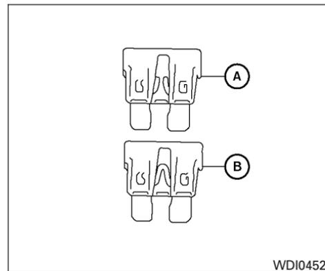
5. Si le fusible est grillé (A), remplacez-le par un fusible neuf (B).
