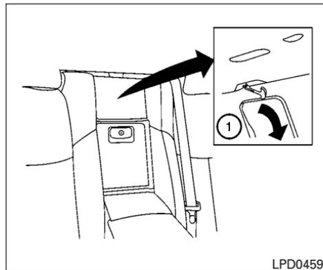
Déverrouillage secondaire du couvercle du coffre (selon l'équipement du véhicule)
