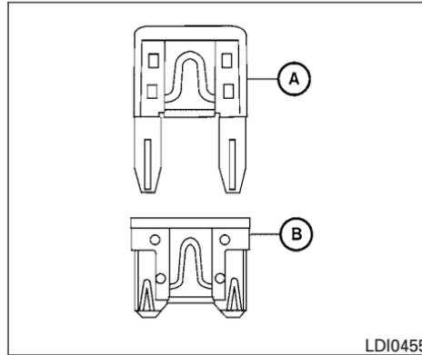
Votre véhicule utilise deux types de fusibles. Les boîtes à fusibles du compartiment moteur utilisent des fusibles de type **(A)**. La boîte à fusibles de l'habitacle utilise des fusibles de type **(B)**.
