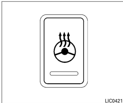
Le système de chauffage du volant ne peut être actionné que lorsque la température superficielle de ce dernier est inférieure à 20 °C (68 °F) environ.
