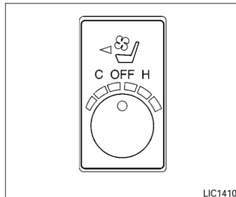
Le siège avant climatisé est chauffé ou refroidi en soufflant de l'air chaud ou froid par la surface du siège. Le commutateur de climatisation des sièges se trouve sur la console centrale.
