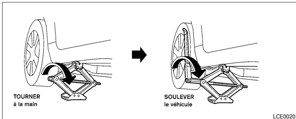
Prenez soin de toujours vous référer aux illustrations appropriées pour les points de mise en place et de levage correspondant à votre modèle de véhicule et au type de cric utilisé.
