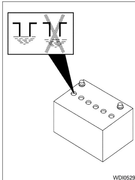
2. Vérifiez le niveau de liquide dans chacun des éléments de la batterie. Si vous devez ajouter du liquide, ne versez que de l'eau distillée pour rétablir le niveau jusqu'au bas de l'orifice de remplissage. **Ne dépassez pas ce niveau.** Remettez les bouchons d'aération en place.
