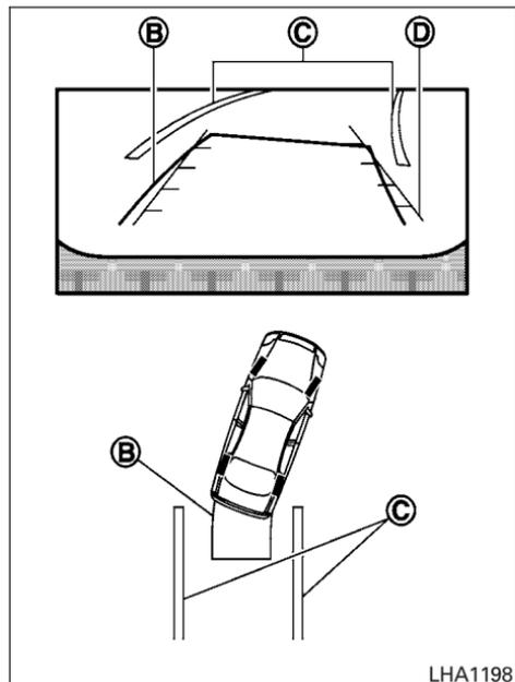
3. Reculez lentement en tournant le volant de façon à ce que les lignes de trajectoire prévue (B) pénètrent dans l'espace de stationnement (C).
