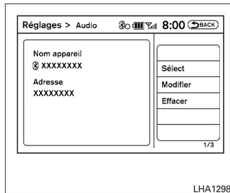
6. Nom appareil et Adresse s'affichent à l'écran. La touche « Sélect » permet de choisir cet appareil comme lecteur audio Bluetooth<sup>MD</sup> actif. La touche « Modifier » permet de modifier les détails du lecteur, par exemple le nom de l'appareil. La touche « Effacer » permet de supprimer l'appareil.
