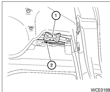
Retirez le cric ① et le démonte-roue ② de la boîte à outils, sur le côté droit du coffre.
