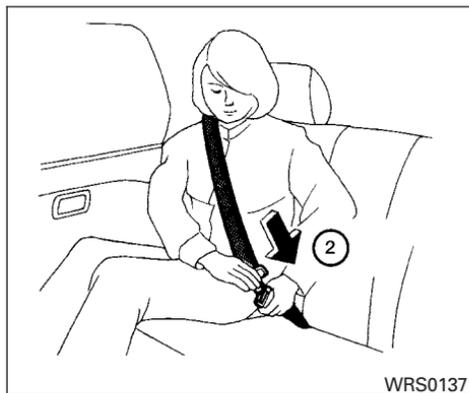
② Tirez lentement la ceinture de sécurité hors de l'enrouleur, puis insérez la languette dans la boucle jusqu'à ce que vous entendiez un déclic et que vous sentiez la languette se verrouiller.
