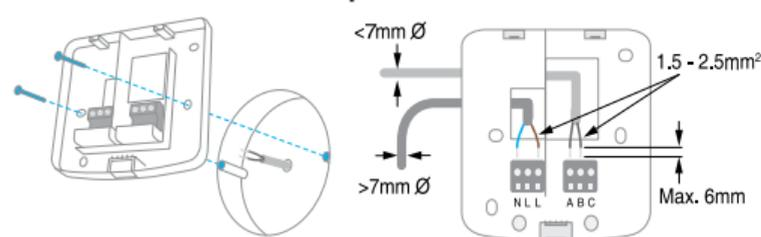
Fixez la base de montage sur la boîte encastrée ou directement au mur, à proximité de la chaudière.
