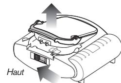
3. Insérez la cartouche dans son logement situé à l'avant du défibrillateur. Un clic se fait entendre lorsque la mise en place est correcte. La poignée verte TIREZ doit être complètement en bas.
