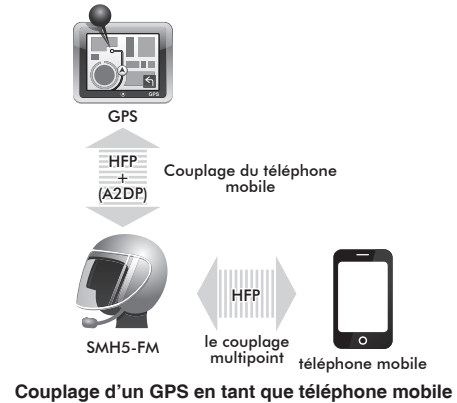
Couplage d'un GPS en tant que téléphone mobile
