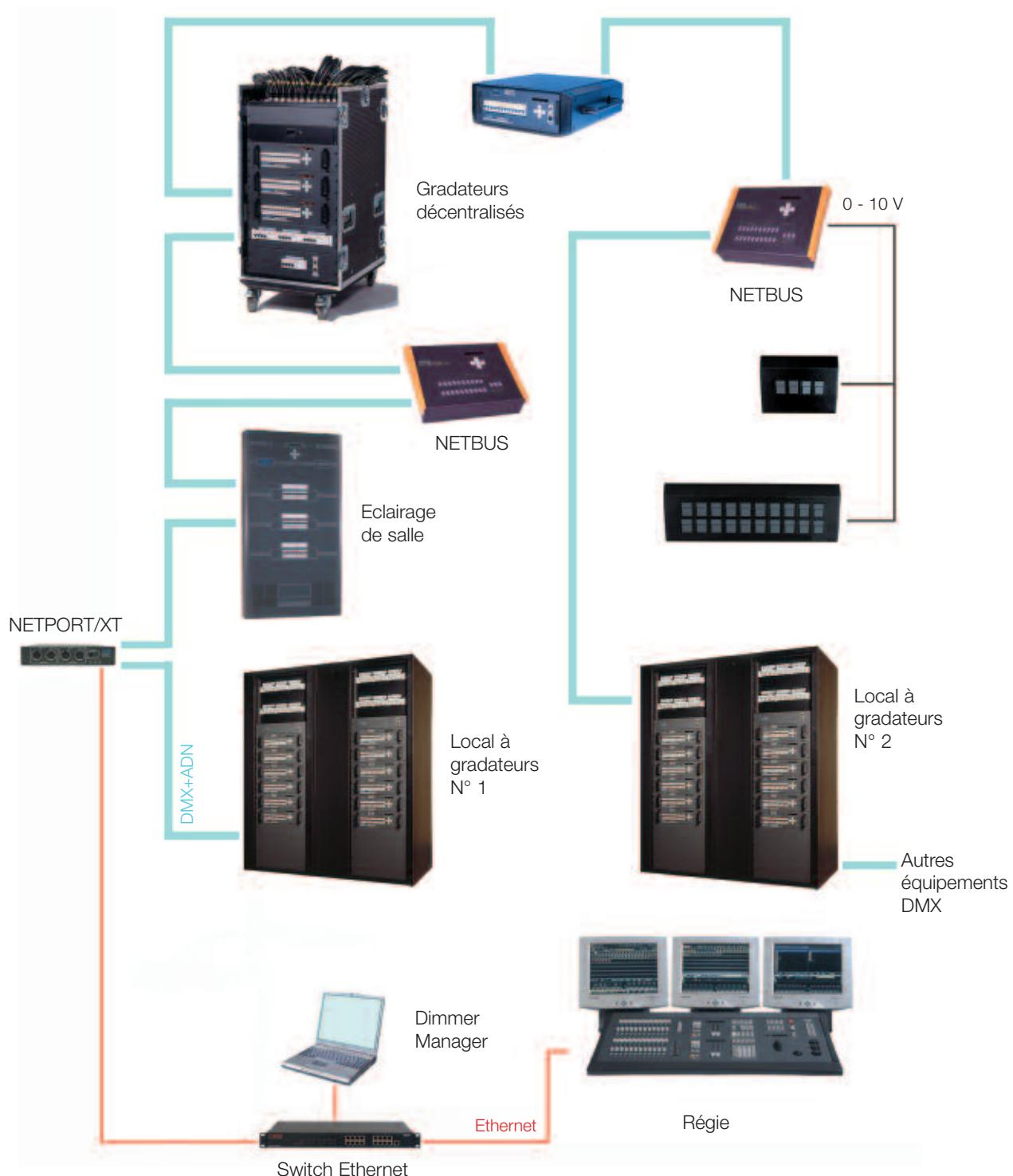
**Note:** le réseau ADN peut être contrôlé par un ou plusieurs NETBUS; ou par un PC Dimmer Manager.
