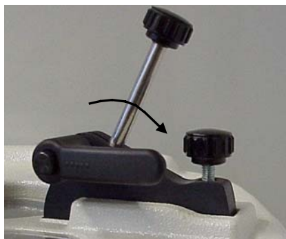
7. mettre la genouillère en position bloquée
