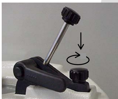
8. diminuer avec la vis (7) la pression du racleur sur le bol du mortier
