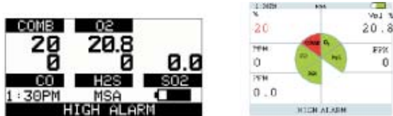
Figura 2-6. Estados de Alarma (en este caso alarma alta)
