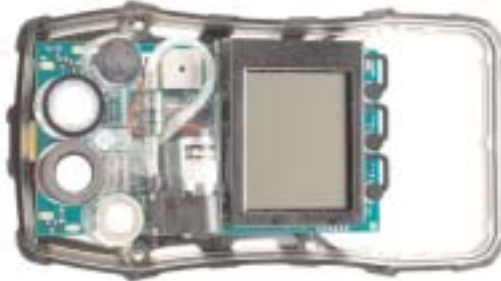
Figure 4-3. Remplacement de capteurs
