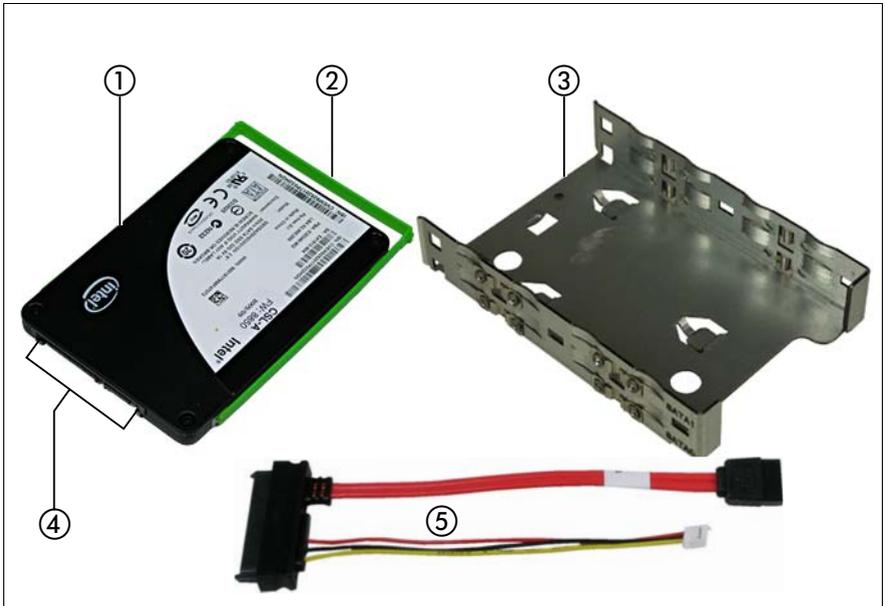
Image n° 11 : Disques SSD 2,5 pouces avec cadre de montage et câble de connexion
