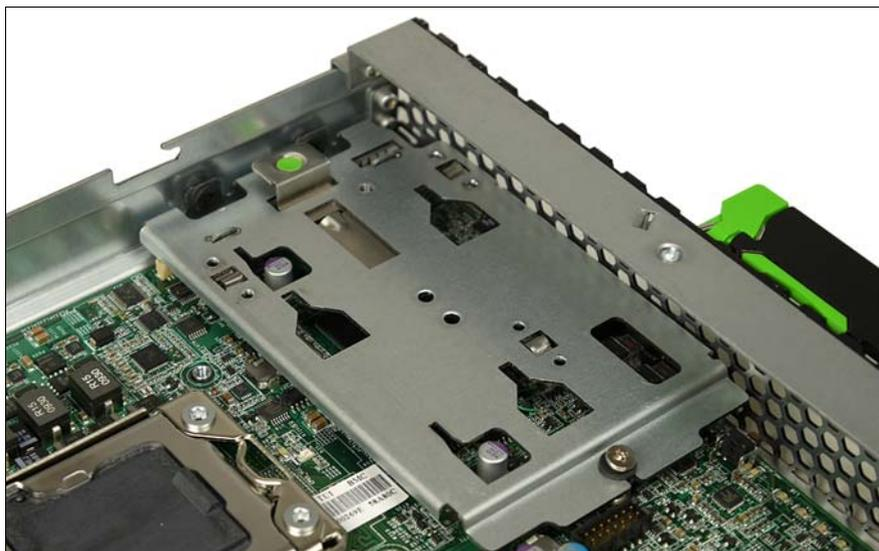
Image n° 21 : Plaque de base pour la fixation du cadre de montage du lecteur SSD
