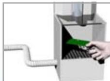
Collecte de particules présentes sur les circuits imprimés après perçage et assemblage
