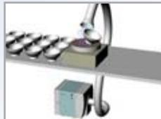
Extraction de particules émises par les opérations de polissage durant la fabrication de céramique
