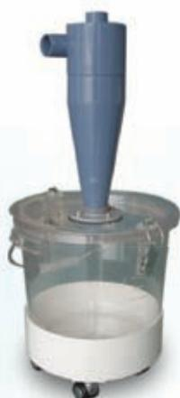
Les poussières pénètrent par le haut du cyclone. Elles sont projetées dans un mouvement rotatif vers les parois et tombent dans le bac par gravité. L'air propre ainsi que les micro particules vont circuler au centre du cyclone dans un mouvement rotatif inverse et sont évacués vers le dépoussiéreur.
