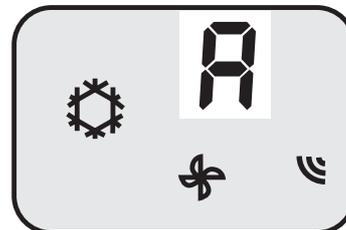
**A**:AUTO Positionnement automatique des ailettes dans la meilleure position selon le mode d'opération sélectionné.
