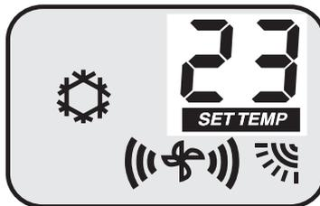
Si la sonde de l'air incorporée dans le Room Controller est activée, le display affichera la température de la pièce au bout de quelques secondes.
