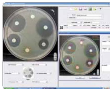
Les **Scan**<sup>®</sup> permettent la mesure de chaque zone d'inhibition au 1/10<sup>ème</sup> de mm près
