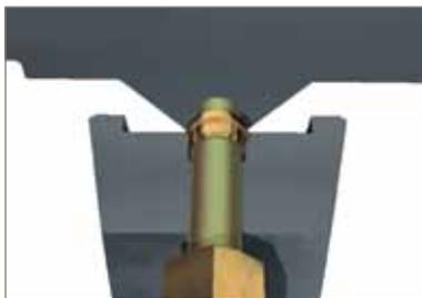
Le tube est inséré dans l'outil jusqu'au point de résistance
