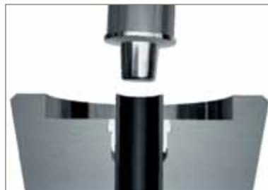
Puis le tube est maintenu par les mâchoires de serrage, le poinçon d'évasement se déplace vers l'avant et exécute un mouvement orbital
