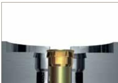
L'extrémité du tube est libérée et peut être extraite de la machine
