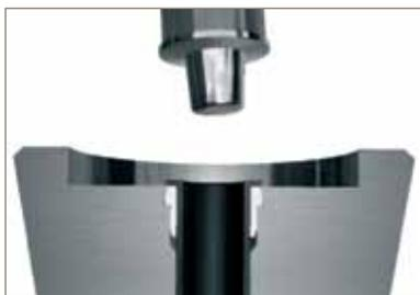
Dès que le contour défini de l'évasement est obtenu, le processus Parflange® est arrêté et le poinçon ressort
