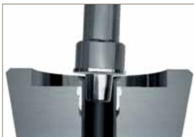
L'évasement débute dès l'entrée en contact de la surface d'usinage du poinçon d'évasement avec l'extrémité du tube
