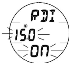
Fig. 47 - RÉGLAGE DE L'ALARME RÉPÉTITIVE D'INTERVALLE DE PROFONDEUR
