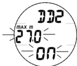
Fig. 49 - RÉGLAGE DE L'ALARME DE PROFONDEUR DE DESCENTE DD2
