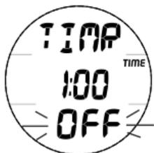
Fig. 15 - MINUTEUR DE COMPTE À REBOURS DE LA MONTRE
