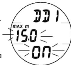
Fig. 48 - RÉGLAGE DE L'ALARME DE PROFONDEUR DE DESCENTE DD1
