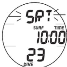
Fig. 29 - ALARME POST-PLONGÉE DE TEMPS DE RÉCUPÉRATION EN SURFACE
