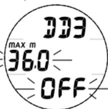
Fig. 50 - RÉGLAGE DE L'ALARME DE PROFONDEUR DE DESCENTE DD3
