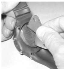
Fig. 67 - RETRAIT DU COUVERCLE DE LA PILE (à l'aide d'un outil)
