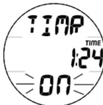
Fig. 58 - ÉCRAN SECONDAIRE DU MODE PLONGÉE ÉTAT DU MINUTEUR DE COMPTE À REBOURS
