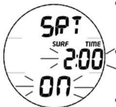
Fig. 45 - RÉGLAGE DE L'ALARME DE TEMPS DE RÉCUPÉRATION EN SURFACE
