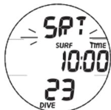
Fig. 64 - ALARME DE TEMPS DE RÉCUPÉRATION EN SURFACE (après une plongée)
