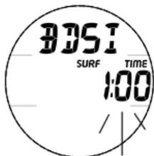
Fig. 55 - RÉGLAGE DE L'INTERVALLE DE SURFACE ENTRE LES PLONGÉES
