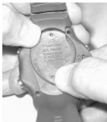
Fig. 68 - RETRAIT DU COUVERCLE DE LA PILE (sans outil)
