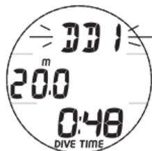
Fig. 63 - ALARME DE PROFONDEUR DE DESCENTE DD1 (DD 2 et 3 similaires)
