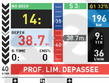
L'alarme continue jusqu'à ce que le plongeur soit suffisamment remonté pour que la ppO<sub>2</sub> revienne dans les limites programmées. Pendant que l'alarme est activée, la fonction de carte est désactivée et la boussole ne peut être appelée que pendant 10 secondes, après quoi l'écran par défaut avec le message d'alerte s'affichent à nouveau.
