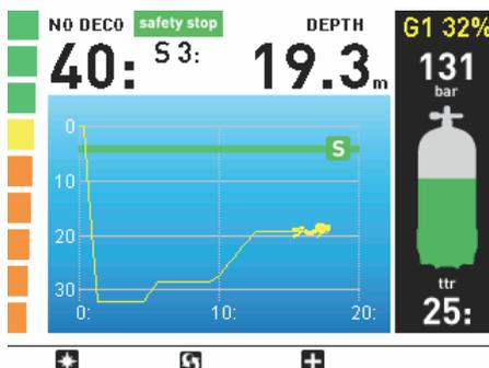
Si vous appuyez sur **+**, le temps de plongée, le CNS% et la température sont également affichés. En cas de plongée avec décompression, lorsque vous appuyez sur **+**, l'affichage zoomez sur les détails de la remontée, en identifiant les trois paliers (au maximum) les plus profonds.
