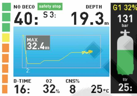
La **profondeur** est donnée avec une précision de 10 cm jusqu'à 99,9 mètres, après quoi elle est donnée avec une précision de 1 mètre. Lorsque la profondeur est affichée en pieds, la précision est toujours de 1 pied. À une profondeur de moins de 1,2 m, l'affichage est ---. La profondeur maximale qui soit possible est de 150 m/492 pieds.
