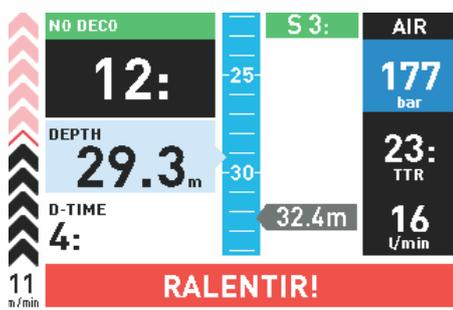
Si la vitesse de remontée est supérieure à 12 m/min (40 pieds/min) à une profondeur plus importante que 12 m (40 pieds), le message sur l'écran change : **REMONTÉE RAPIDE**. Si une vitesse supérieure à 12 m/min (40 pieds/min) est maintenue sur les deux tiers ou plus de la profondeur à laquelle l'alarme a été déclenchée, l'Icon HD considère qu'il s'agit d'une violation et affiche **ERR - REMONTÉE**.
