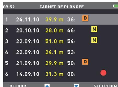
En appuyant sur **SÉLECTION**, vous aurez accès aux détails de la plongée, et de là vous pourrez accéder aux profils de profondeur et de température de cette plongée.
