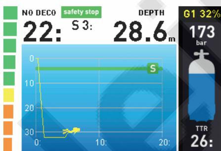
Au cours de la plongée, vous pouvez librement passer du mode **EXTENDED** au mode **PROFILE** en appuyant sur **S**, et il est possible d'appeler la boussole numérique depuis l'un ou l'autre mode. L'affichage de la boussole présente aussi les informations de profondeur et de temps restant sans décompression (ou la durée totale de la remontée en cas de plongée avec décompression).
